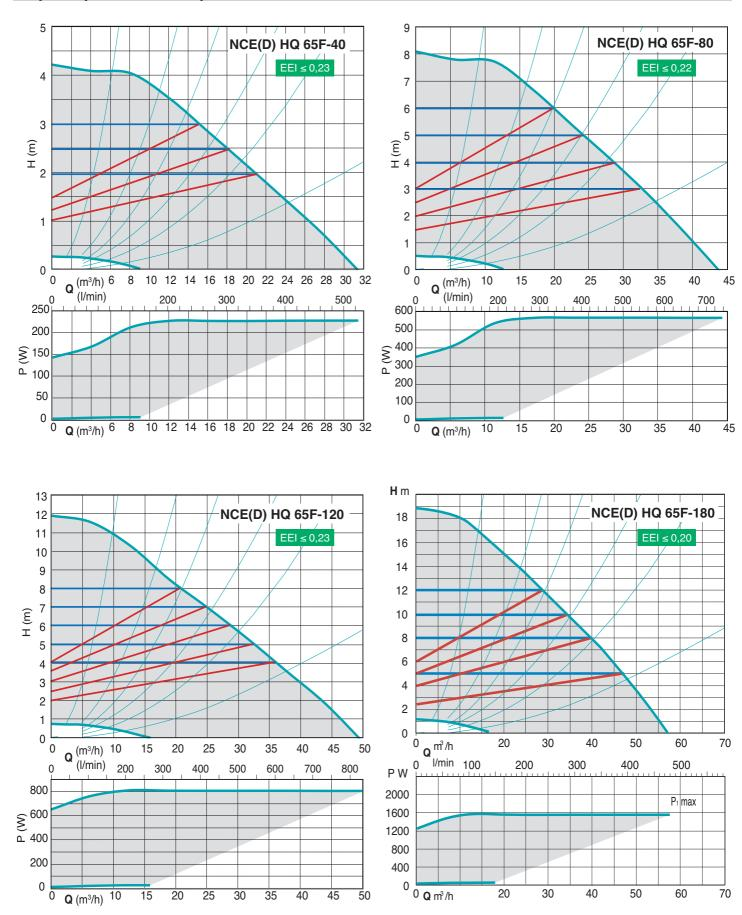
**Циркуляционные насосы с высокой энергетической Эффективностью с фланцевыми патрубками**
