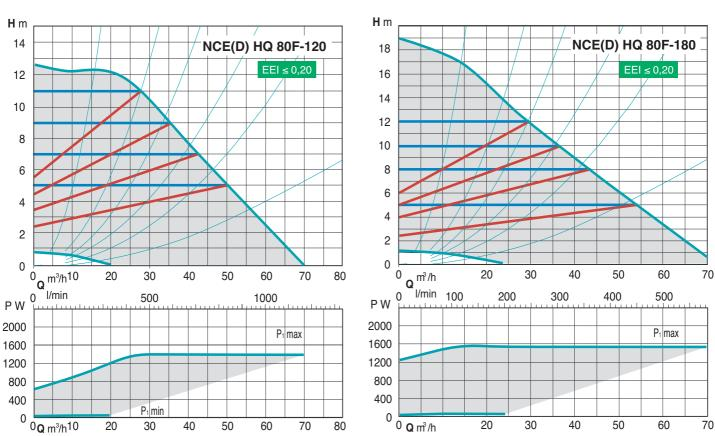
**Циркуляционные насосы с высокой энергетической Эффективностью с фланцевыми патрубками**
