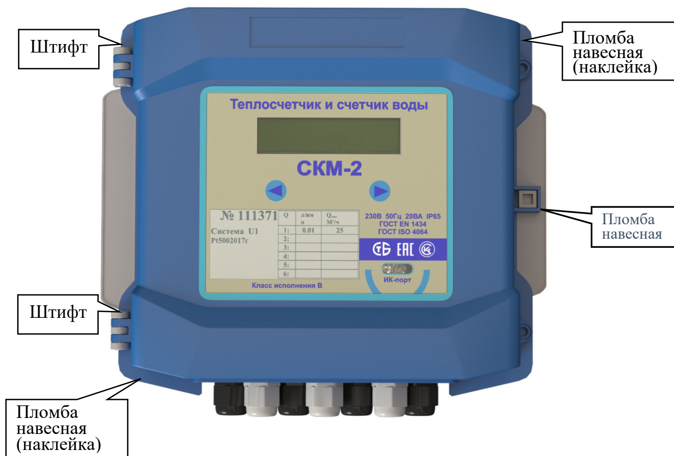
Рисунок В.3 Возможные места пломбирования вычислителя СКМ-2 многоканального.
